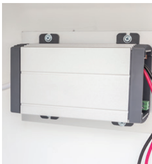
Automaattilaturi varmistaa akun latauksen aina kun vaunu on kytketty verkkovirtaan.
