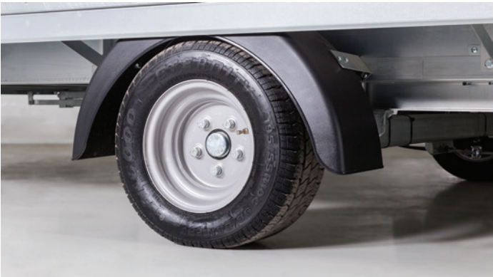
Kioskivaunun pyöräkoko on normaalia pienempi jotta palvelutiski laskeutuu alemmaksi ja asiakaspalvelu helpottuu.
